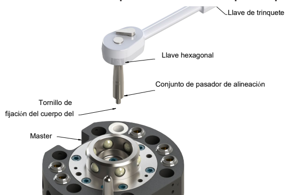
Figura 6.7—Sustitución del pasador de alineación: parte superior
