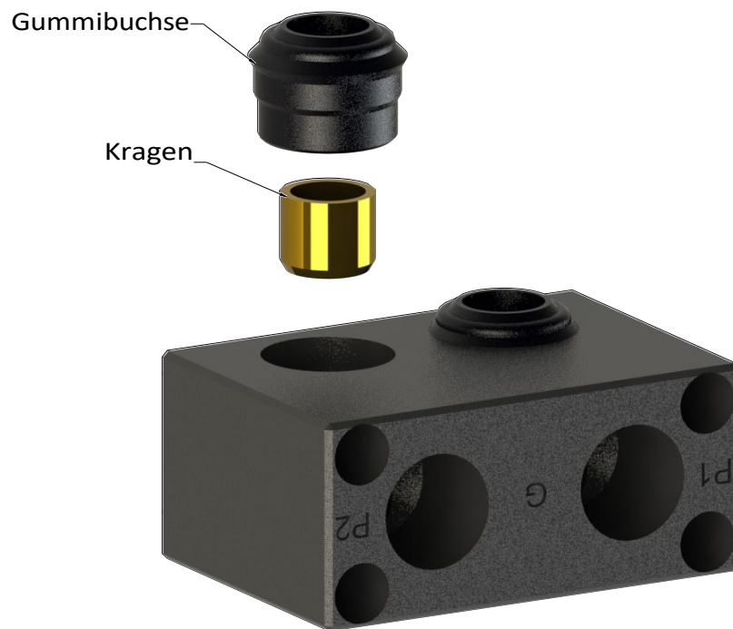
Abbildung 5.5 – Austausch der Gummibuchse
