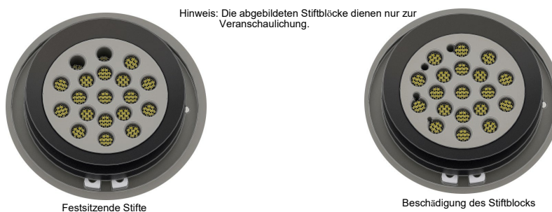
Abbildung 5.3 – Festsitzender Stift und Beschädigung des Stiftblocks
