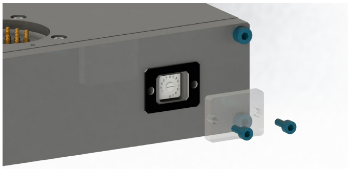
Figura 3.2: Identificación mediante interruptor giratorio
