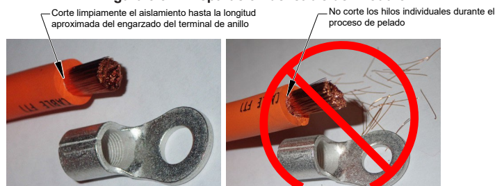
Figura 3.5— Preparación del cable del módulo
