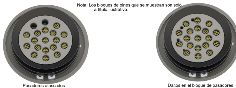
Figura 5.3: Pin atascado y daños en el bloque de pines
