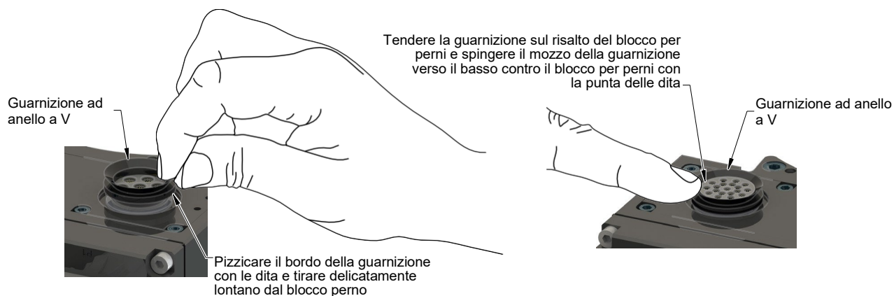
Figura 5.4—Sostituzione della guarnizione ad anello a V
