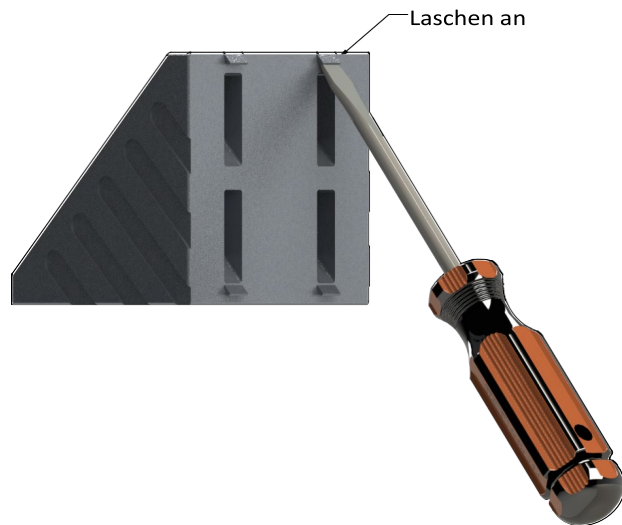
Abbildung 2.3 – Entfernen der Laschen an Verstärkungsblechen
