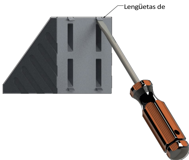
Figura 2.3: Retirada de las lengüetas de los refuerzos
