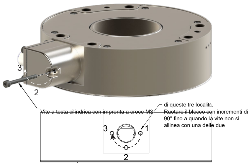
Figura 3.4 — Regolazione dell'orientamento del blocco connettore
