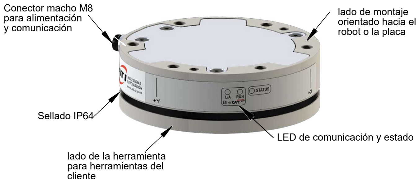
Figura 2.1: Sensor Axia FIT con EtherCAT
