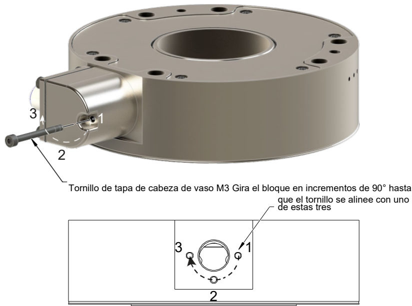
Figura 3.4—Ajustar la orientación del bloque de conectores
