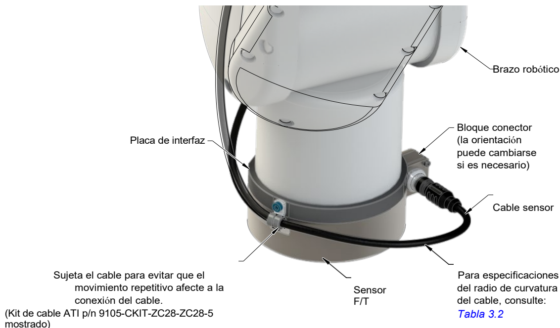
Figura 3.2—Enrutamiento del cable sensor
