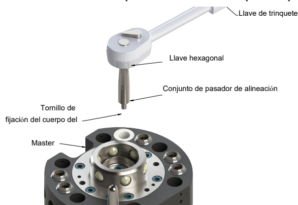
Figura 6.7—Sustitución del pasador de alineación: parte superior
