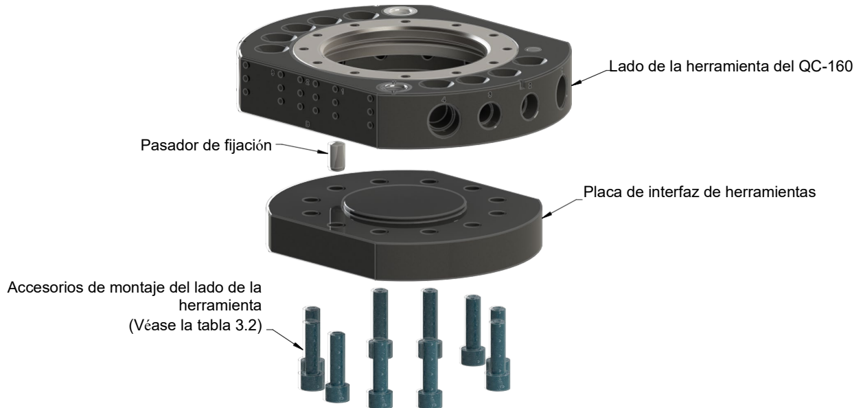
Figura 3.2: Instalación del cambiador de herramientas en el robot (se muestra el modelo QC-160)
