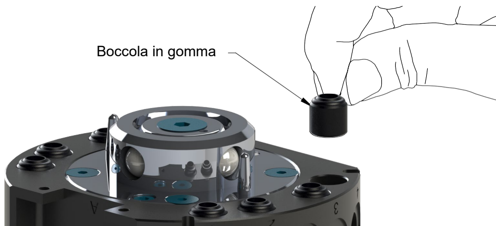
Figura 6.5 — Sostituzione della boccola in gomma
